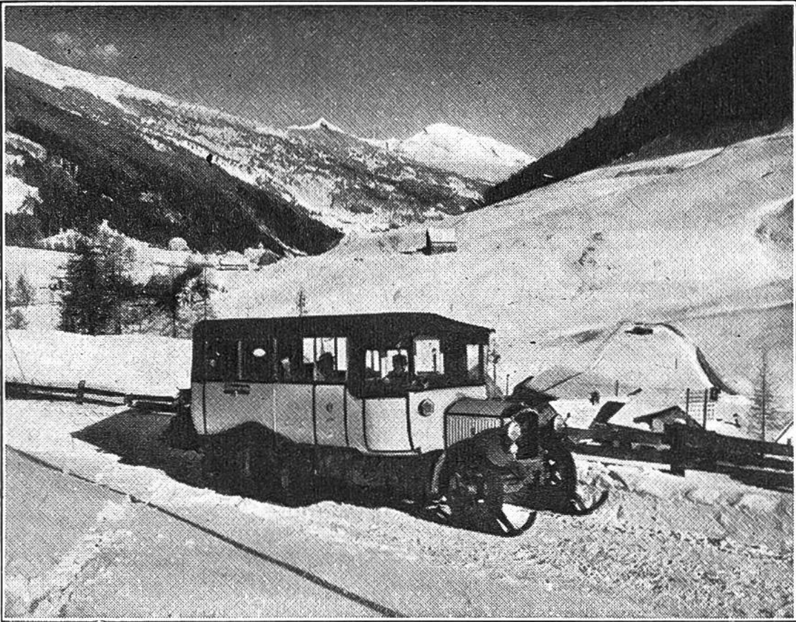
Die Automobilpost Chur-Lenzerheide (1476 m ü. M.) im Winter. Das Raupenauto mit skiartigen Kufen fährt auf der Schneebahn gleich sicher wie ein gewöhnliches Fahrzeug auf schneefreier Straße.
