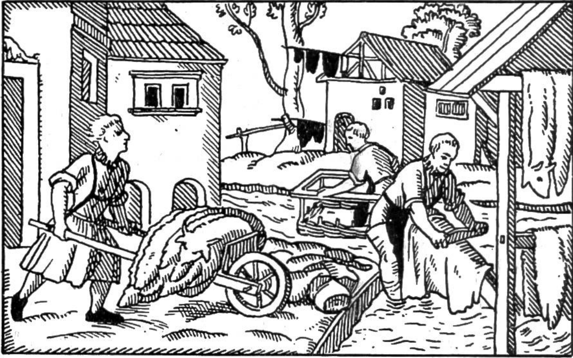
L e d e r f a b r i k a t i o n . Gerber beim Bearbeiten der Tierhaut auf dem „Schabebaum“. Bild aus dem 16. Jahrhundert.
