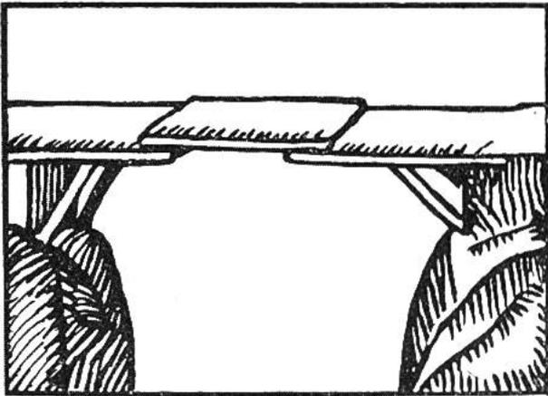
Auslegerbrücke; das Mittelstück wird von den beiden balkonartigen Seitenstücken getragen.
