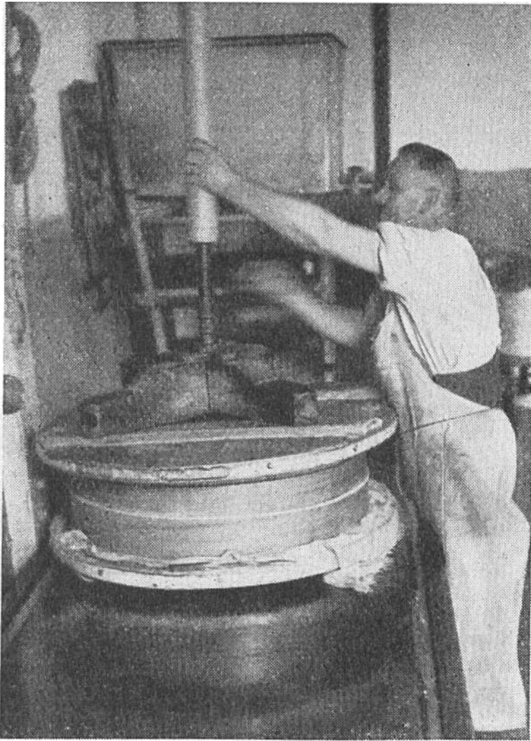
9. Die Käsemasse befindet sich samt dem Käsetuch in der Käseform und zwischen zwei Deckeln. Der Käser ist im Begriff, die Press-Vorrichtung daraufzusetzen.
