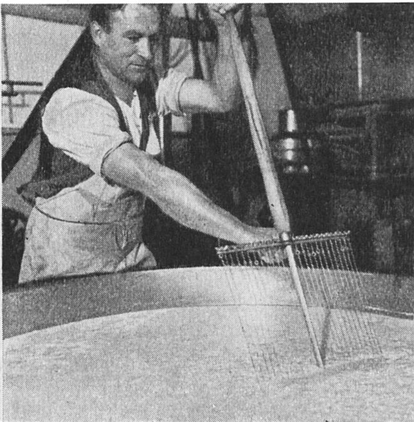
6. Mit der „Käseharfe“ wird gerührt und dabei der „Bruch“ immer kleiner gemacht.
