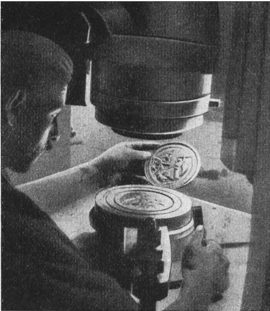
Moderne elektrische Prägepresse. Vorder- u. Rückseite der Medaille werden mit einem Schlag geprägt.
