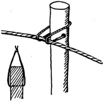
zusammengeknüpft, dass sie noch etwa 5 cm über die Stange hinausragt. Die Schnur wird nun um das gespannte Wäscheseil herumgenommen und dann über das Stützenende gestülpt. Beim Aufrichten der Stütze trägt die Schnur das Wäscheseil. Der Wind ist machtlos geworden, die Stütze kann nicht mehr umfallen!
