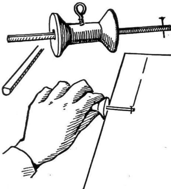
**Streichmass.** Nach Mitteilung von Willi Haari, 14 Jahre, Matten i. S. Durch eine leere Fadenspule wird ein Rundstäbchen gesteckt, das oben mit einer Feile etwas abgeflacht worden ist. Eine Ringschraube in der Mitte der Fadenspule dient als Stellschraube und ein Nagel am einen Ende des Stabes zum Anzeichnen des gewünschten Masses auf dem zu bearbeitenden Holz.
