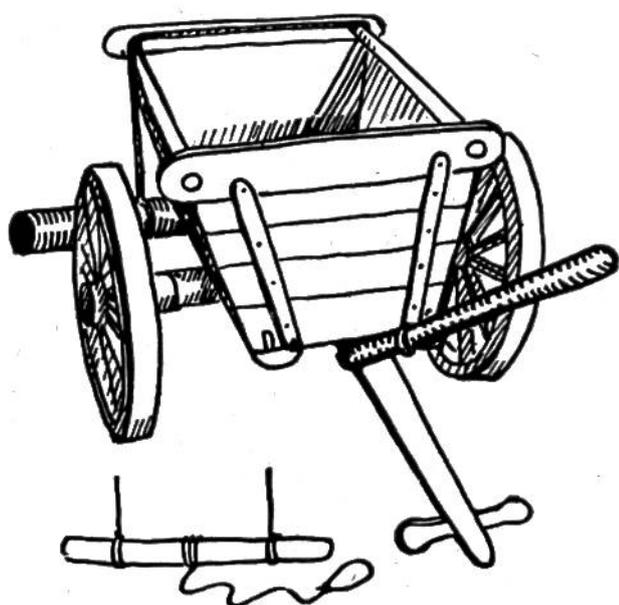
wir den Strick am Ende eines Reitels (Knebel) befestigen,  $\frac{1}{3}$  soll gegen die Deichsel, die andern  $\frac{2}{3}$  gegen aussen schauen. So kann durch Drücken des Reitels nach hinten eine grosse Last sicher gebremst werden.
