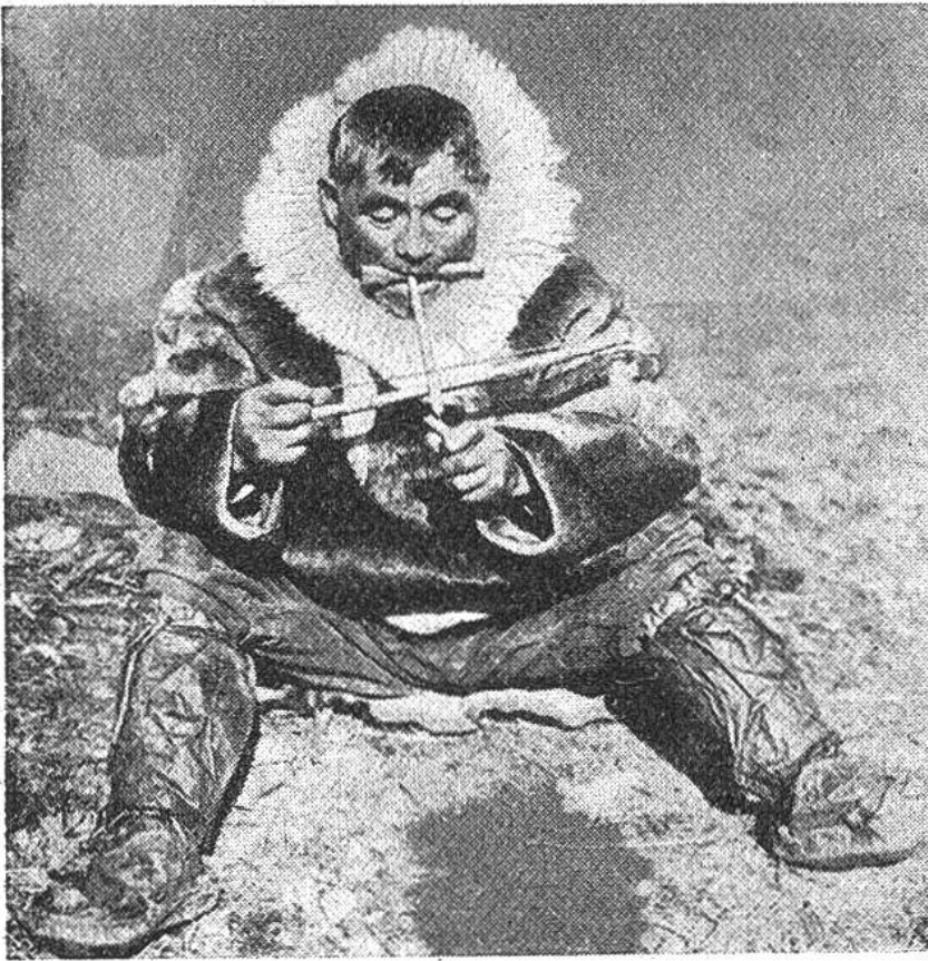
Alaska-Eskimo mit Drillbohrer; dieser wird mit Hilfe eines Mundstückes festgehalten und mit einer Art Bogen in Bewegung gesetzt.
