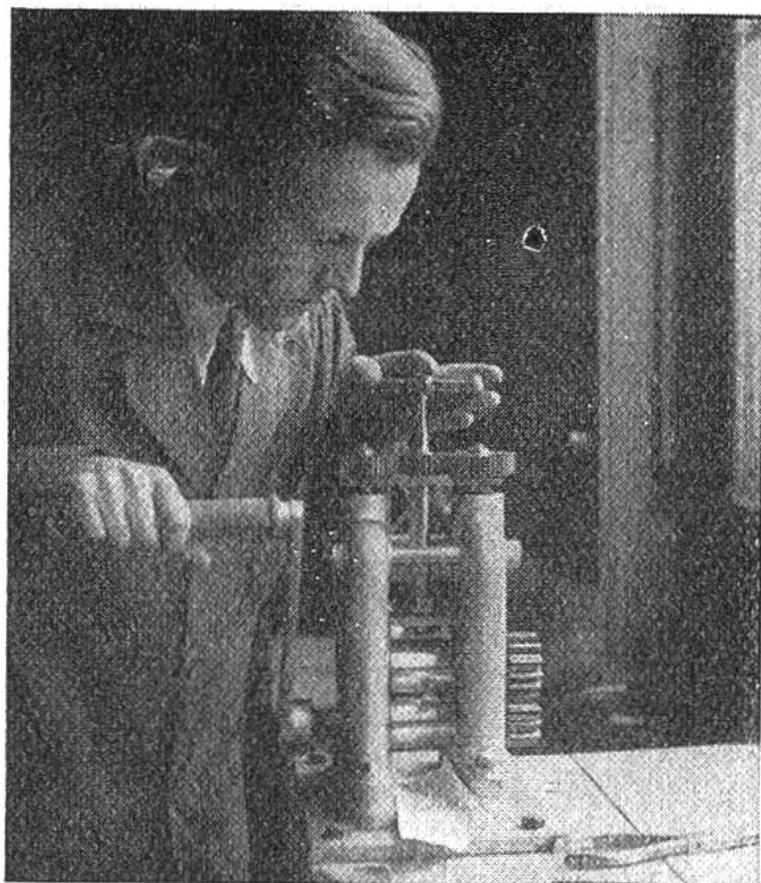
Auf der Walze werden die Stückchen Edelmetall, die durch die Feuerprobe geprüft werden sollen, zu ganz feinem Blech ausgewalzt.
