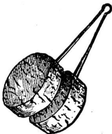
**Praktischer Kerzenlöscher.** Nach Mitteilung von Walterli Gmür, 8 Jahre, Zürich. Die Kerzen mit den Fingern löschen, geht nicht so gut wie mit diesem kleinen Korkkerzenlöscher. In zwei etwa 1 cm dick zugeschnittene Scheiben eines Korkzapfens wird seitwärts eine Agraffe (Splint) eingesteckt, wie die Zeichnung zeigt.
