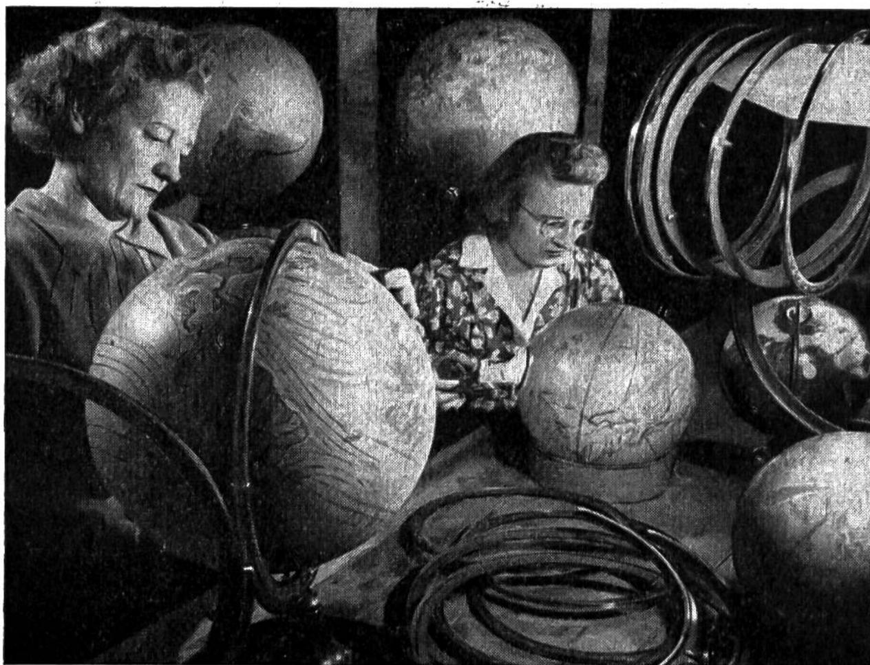
Wenn der Globus durch eine Lackschicht den endgültigen Glanz erhalten hat, erfolgt der Aufbau der Kugel mit Meridian (Messkreis) und Fuss.
