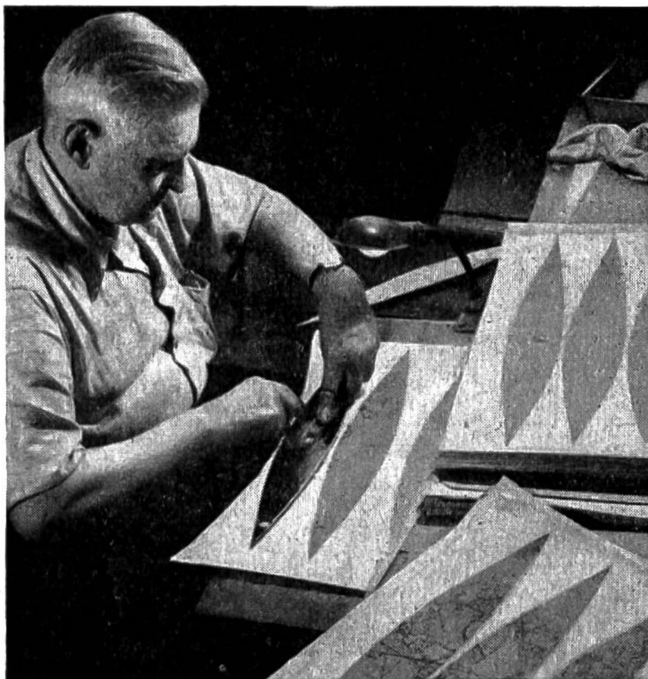
Nachdem das Kartenwerk in Schnitzform auf einen grossen Bogen gedruckt ist, muss es vom Buchbinder genau ausgeschnitten werden; dazu verwendet er Schablone und Messer.
