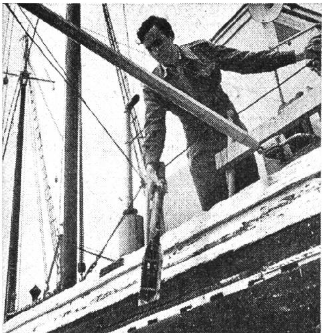
Ein «Bathythermograph». Hinter diesem komplizierten Wort steckt ein sinnreicher Apparat, der die Temperatur in verschiedener Meerestiefe aufzeichnet.
