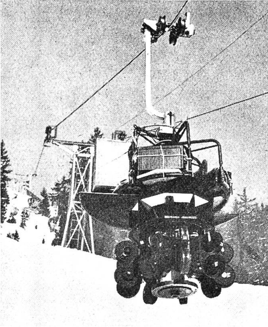
An Stelle des Sessels fährt der Aufnahmeapparat mit den neun Kameras in die Höhe.
