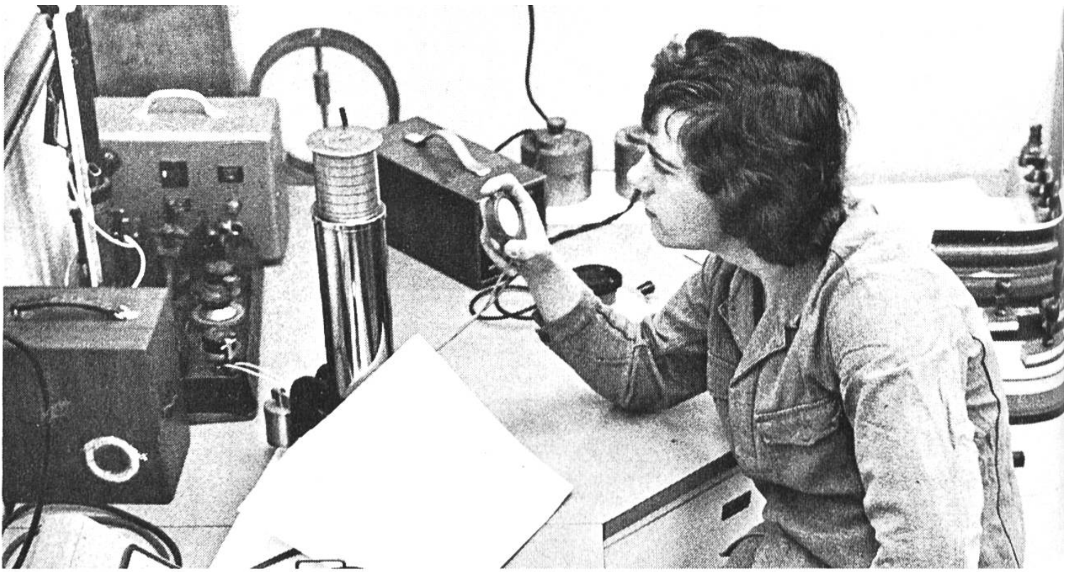
Im Labor werden die Eigenschaften des Papiers untersucht und mit den vorgegebenen Werten verglichen.
