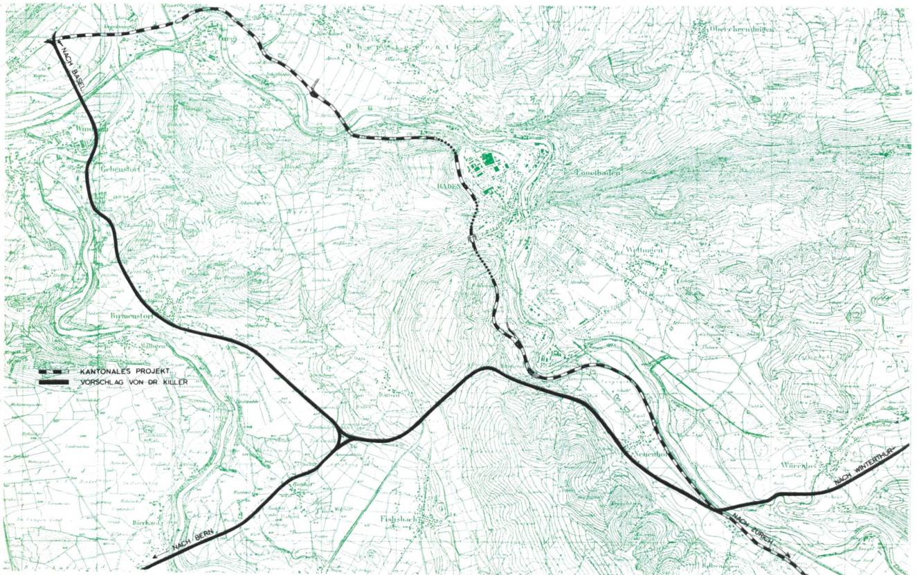
Abb. 9. Vergleich des offiziellen Hauptstrassenprojektes mit dem Vorschlag von Dr. J. Killer in der Gegend Badens.
