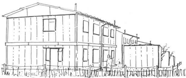
Abb. 5. Vorfabrizierte Notwohnungen aus der Zeit unmittelbar nach dem Kriege, die bereits wieder als erneuerungsbedürftig beurteilt und durch Häuser in «traditioneller» Bauweise ersetzt werden.
