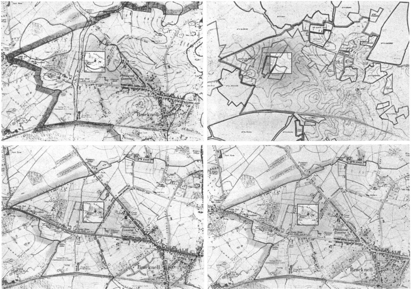
Abb. 5. Entwicklungskarten zum Generalplan der Neuen Stadt von Bracknell: Die vier Karten (über Geologie, Landwirtschaft, Wasserversorgung, Topographie) gehören einer Serie von 29 für diesen Generalplan angefertigten Karten an.
