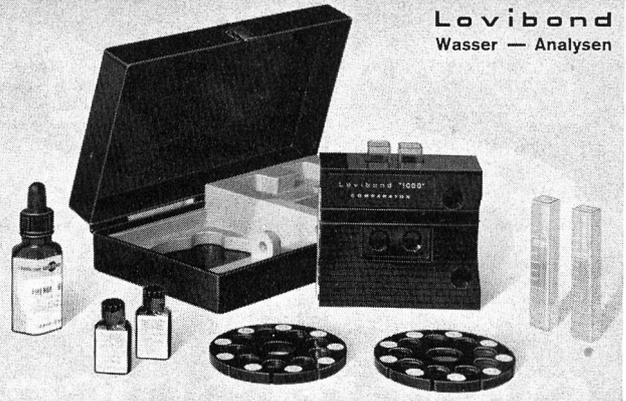
Das «LOVIBOND 1000»-Komparator-Programm ermöglicht über 60 verschiedene Wasseranalysen. Meistens werden diese Untersuchungen im Labor durchgeführt, aber häufig muss auch im Feld an Ort und Stelle gearbeitet werden. Dazu bieten wir komplette Felddarstellungen, die alle erforderlichen Geräte und Chemikalien für die entsprechenden Tests enthalten.
