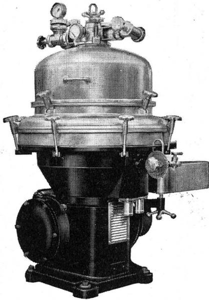
Schlammverdickungsanlagen mit Separatoren
