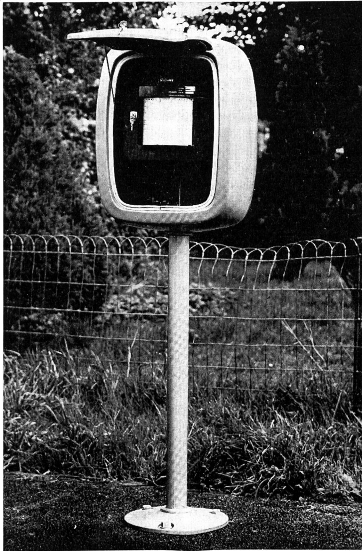
Durchflussregistriergerät in Fiberglasgehäuse, steht 150 m von der Messstelle entfernt.
