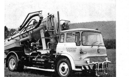
Abb. 6. Der Mini-Mammut für Containerentleerung ist speziell für den Einsatz auf engen Strassen, im Gebirge ausgelegt. Maximale Breite 1800 mm, Kasteninhalt 5 m 3 . Ladefähigkeit etwa 20 m 3 losen Materials
