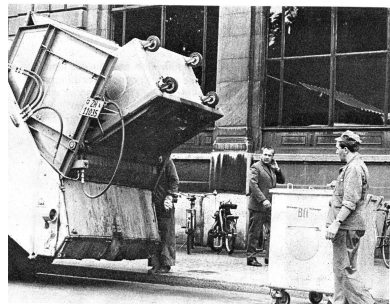
Abb. 2 Der immer grösser werdende Anteil an sperrigem und leichtem Müll stellt vielfältige Anforderungen an einen modernen und leistungsfähigen Müllwagen. Der Kuka-Halfsch mit drei Verdichtungsphasen ist dieser Entwicklung angepasst worden. Die drei Phasen bestehen aus: 1. Vorverdichtung beim Einfüllen im Förderrad, 2. Umwälzverdichtung durch drehenden Behälter, 3. Schlusspressung durch Pressschnecke am hinteren Deckel
