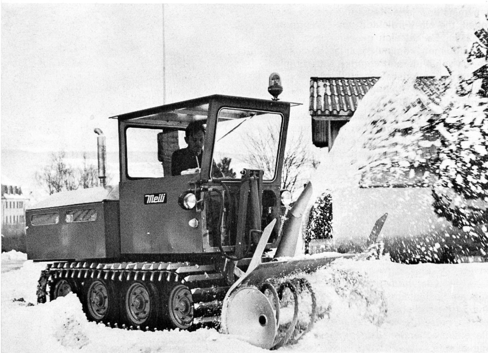
Abb. 10. Klein, aber dennoch leistungsfähig. Meili-Raupenfräse mit hydrostatischem Antrieb
