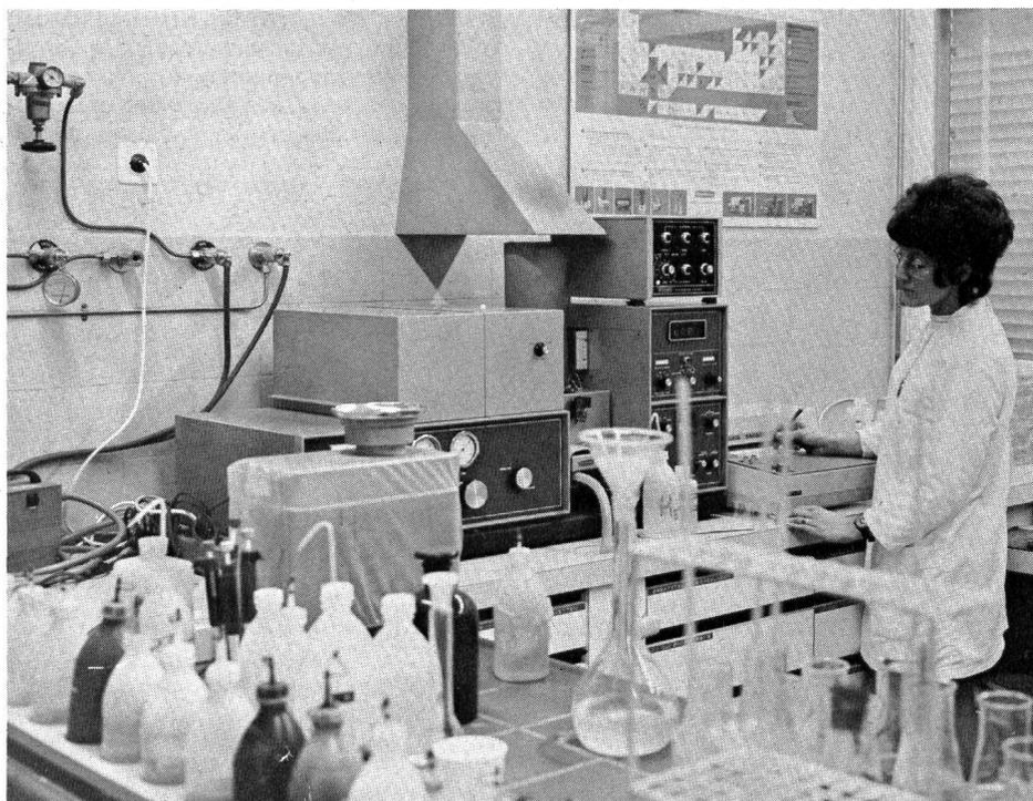
Abb. 4. Ohne schnelle und exakte Analysenmethoden lassen sich abwassertechnische Anlagen nicht überwachen. Unser Bild zeigt einen Ausschnitt aus dem Betriebslabor der Autophon AG. Die AAS-Methode (Atom-Absorbtion-Spektrometrie) gibt Aufschluss über die Metallgehalte der Lösungen
