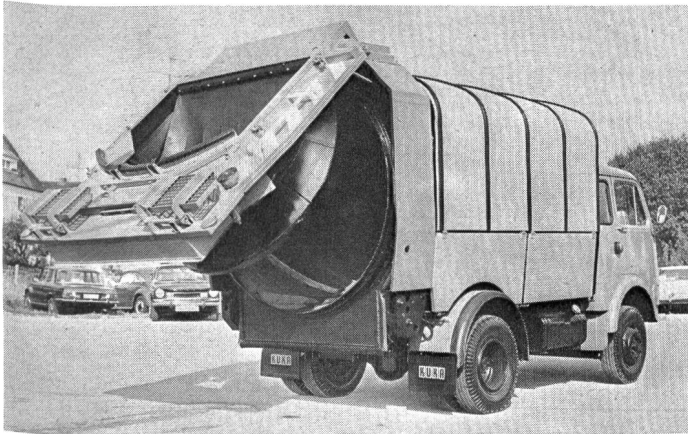
Abb. 2. Der Kleinste: der Kuka-Mini-Müllwagen mit 6 m 3 Inhalt
