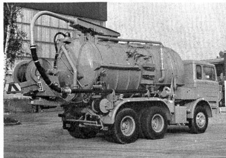
Abb. 6. Ein Kombifahrzeug, für die Hochdruckreinigung wie als Schlammsaugfahrzeug gleichermaßen geeignet, mit 12 m 3 Inhalt
