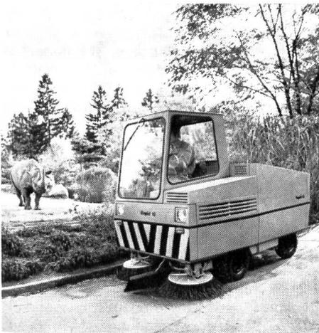
Strassen geholt, unebene Strassen sind für die Rapid 10 kein Hindernis. Von grösster Bedeutung ist, dass mit diesem Aufnahmeprinzip die äusserst giftigen Abriebteilchen von Autoreifen und Strassenbelag, die mit Öl- und Abgas gesättigt sind, restlos aufgenommen werden. Das Kehrgut wird mit zwei seitlich an der Maschine hydraulisch angetriebenen und stufenlos einstellbaren Seitenbesen aus dem Rinnstein vor das Saugmundstück transportiert. Der Staub wird mittels Wasserdüsen, die
