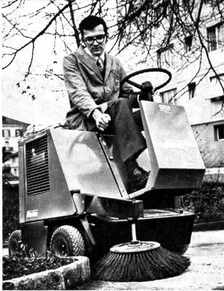
Abb. 6. Sobald Innen- und Aussenflächen ständig saubergehalten werden müssen, lohnt sich der Einsatz einer Spezialkehrmaschine. Diese hier arbeitet bereits wirtschaftlich, wenn eine Arbeitsstunde mehr als einen Franken kostet
