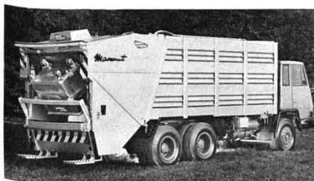
Mammut 3-Achs-Kehrichtwagen mit 20 m 3 Kasteninhalt und einer Ladefähigkeit von 12 t verdichtetem Haushaltkehrich
