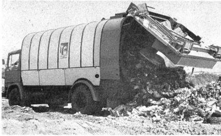
Abb. 3. Kuka-verdichteter Kehricht beansprucht in der Deponie weniger Volumen und verrottet schneller
