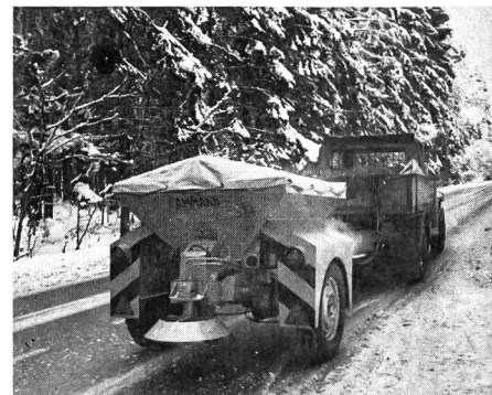
Salz- und Splittstreuer-Anhänger AMA-6H und 15H Inhalt 750 l und 1500 l
