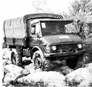
*Der echte Allradantrieb auf 4 gleich grosse Räder und dazu Differentialsperrren in beiden Achsen lassen den Unimog auch noch da fahren, wo alle Wege enden: zum Beispiel auf Trümmerschutt*
