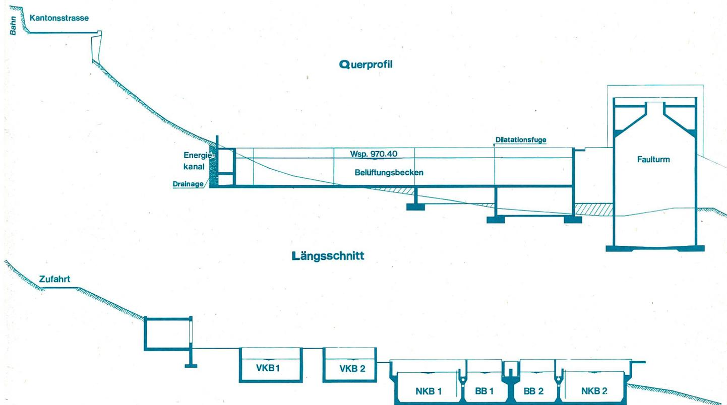
Wasser hauptsächlich aus Waschmitteln anfallende Phosphor durch Zugabe von Fällungsmitteln ins Belüftungsbecken und Absetzung im Nachklärbecken weitgehend eliminiert. Den geologischen Verhältnissen mit dem schlechten Baugrund aus heterogenem Bergsturzmaterial wurde grundsätzlich mit weitgehender Entlastung durch Abfuhr von Aushubmaterial begegnet. Damit werden die zukünftigen Bodenpressungen aus den Beckenlasten eher geringer und diejenigen unter den Fundamenten nur un-
