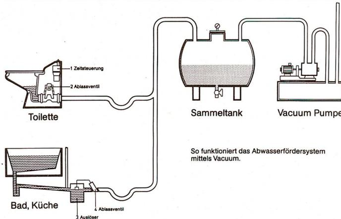
So funktioniert das Abwasserförderungs-system mittels Vacuum.
