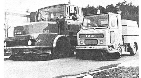
▲ **Faun – selbstaufnehmende Strassen-kehrmaschinen AK 414 HW und AK 320 HB**
