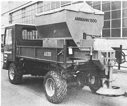
Aufsetzstreuer Ammann 1500 für Kommunalfahrzeuge, Behälterinhalt 1,5 m<sup>3</sup>
