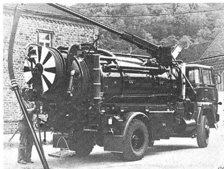
Auf *Abbildung 2* sieht man einen Schlamm- und Hochdruckspüleinrichtung Typ 8000 mit Magirus-Deutz-Fahrgestell Typ M 160 D 16 FL. Entleerung und Unterteilung der Schlamm- bzw. Wasserkammer erfolgt durch pneumatische Ausstossplatte. Leistungsdaten: Vakuumpumpe Wittig 900 m<sup>3</sup>/h, Hochdruckpumpe Uraca, 400 l/min bei 100 atü, mit Druckregelautomatik.
