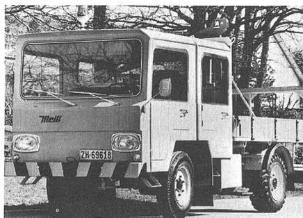
Meili M-1500 mit Doppelkabine und Ladebrücke mit Master-Kran für den Kommunaleinsatz. 50-PS-Perkins-Dieselmotor, heizbare Windschutzscheibe, gefederter Fahrersitz
