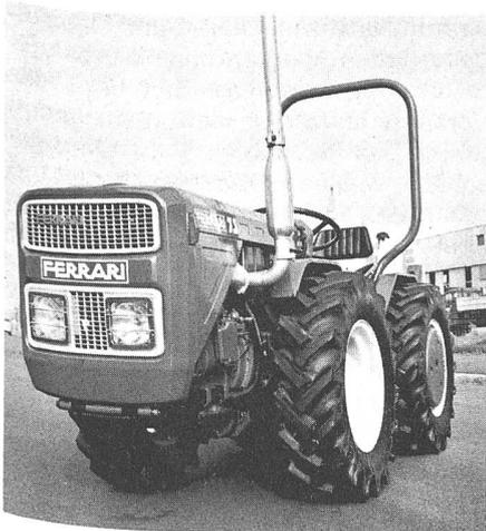
Spur und Differentialsperre; Vorderachse mit verstellbarer Spurbreite; mechanische Zahnstangenlenkung; Bremsen auf Hinterachse mit Doppel- oder Einzelradbremsung; unabhängige Handbremse; hydraulische Geräteaushebung und 2-Punkt-Geräteanbau hinten, Anhängerkupplung; gefederter, verstellbarer Fahrersitz.
