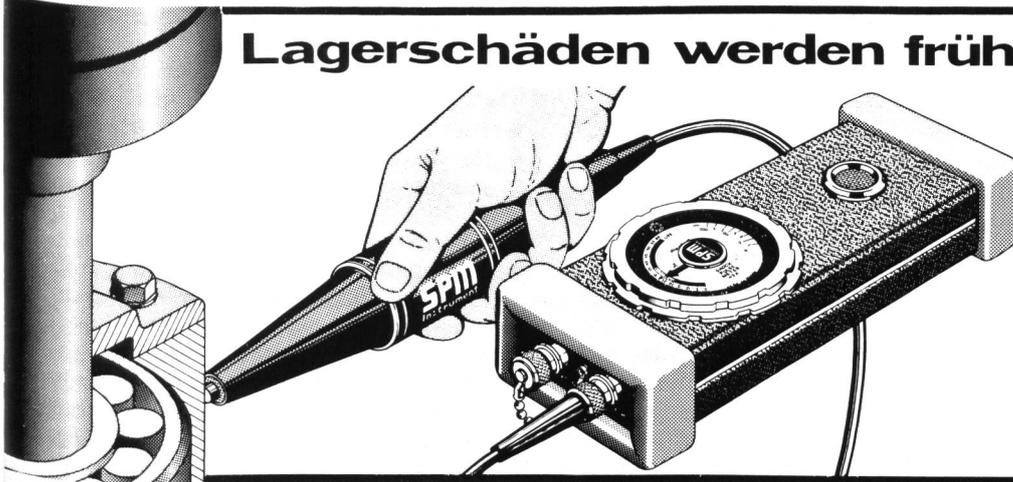
Wälzlagerkontrolle mit der SPM-Methode ist einfach, zuverlässig und hat sich weltweit bewährt.
