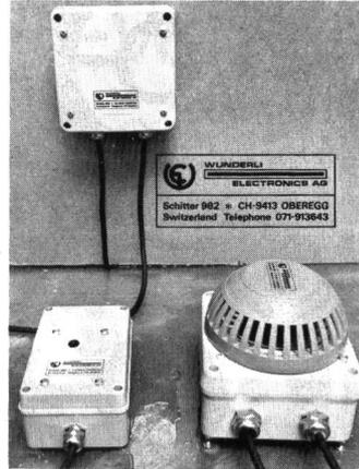
Flüssigkeiten an. Ein Sensor, montiert im Gehäuseinnern, überwacht den Zwischenraum von Auflage (Boden) zu Geräteunterseite. Der Sensor kommt mit der Flüssigkeit nicht in Berührung, sondern «tastet» durch den Gehäuseboden hindurch.
