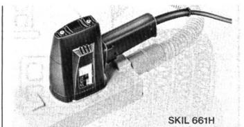
besonders feinen Schliff und vibrationsarmen Lauf. Rohe und lackierte Werkstücke werden gleichermassen sauber und schnell bearbeitet. Technische Daten des Modells 661 H: Schleifplatte 90x185 mm, Schleifpapier 93x230 mm, Leistungsaufnahme 200 Watt, Leistungsabgabe 110 Watt, Leerlaufdrehzahl 10 000 Umdrehungen pro Minute, Hubzahl 20 000 /min.
