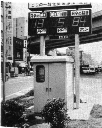
12 Monate) zuverlässig funktionieren, sowie durch den entsprechenden Geräteaufbau, der den einzelnen Analysatoren selbständiges Messen erlaubt, das heisst, sie sind nicht auf ein spezielles Probenentnahmesystem angewiesen. Die jeweiligen Analysatoren enthalten eigene Probenentnahmesysteme (Filter, Kühlaggregate, Pumpen), Gasgeneratoren zur Erzeugung von Nullgas mit Katalysatoren. Sie enthalten ebenfalls eine automatische Eicheinrichtung
