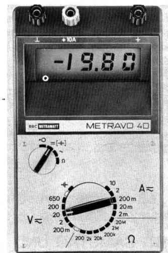
bis 250 V ≈ in allen Messbereichen (ausser 10-A-Bereich). Die robuste Konstruktion gewährleistet, insbesondere mit einer Gummischutzhülle, einen weitgehenden Schutz bei rauher mechanischer Beanspruchung. Das Gerät arbeitet netzunabhängig mit handelsüblichen Mignonzellen. Der Stromverbrauch ist dank den elektronischen Bausteinen in LSI-Technik und der Flüssigkristallanzeige ausserordentlich gering. Abmessungen: 110 × 181 × 62 mm, Gewicht 750 g einschliesslich Batterien.
