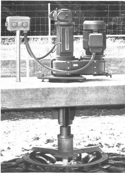
**KISSLING-Getriebe mit verlängerter Nabe und automatischer Höhenverstellung.**
