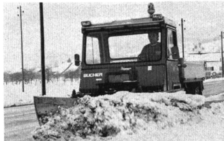
Bucher-Transporter TR 2500-K mit Schneepflug Zaugg G 10 V, Fahrzeug mit 40-PS-Motor, 6 Vorwärts-, 2 Retourgänge, Allradantrieb, Tragfähigkeit auf Chassis 3250 kg.
