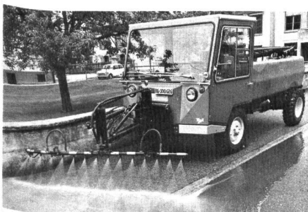
Kommunal-Transporter TP 50 mit hydraulischem Schneepflug (oben) und TP 35 K mit Schwemmeinrichtung.
