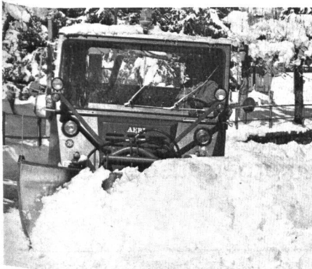
Kommunal-Transporter TP 50 mit hydraulischem Schneepflug (oben) und TP 35 K mit Schwemmeinrichtung.
