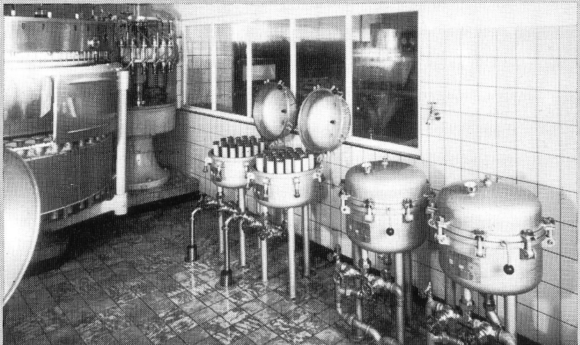
Katadyn-Filtergruppe Typ MF-31 für Wasser-Entkeimung
