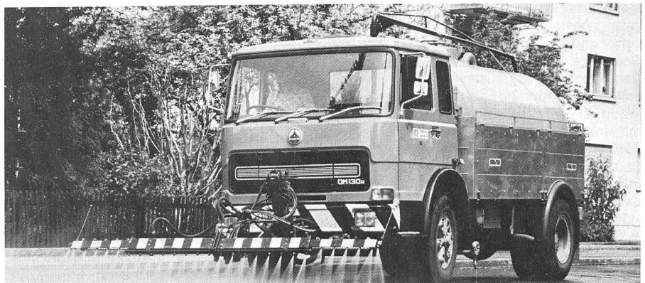
Saurer-OM-Lastwagen, Typ 130 R, mit Tank und Strassenreinigungsanbau ausgerüstet: Mit Tank und Strassenreinigungsanbau ausgerüstet, 13 t Gesamtgewicht und kleine Ausmasse prädestinieren den Saurer OM 130 R besonders für Aufgaben in der Strassenreinigung. Die Saurer-OM-Reihe umfasst ein Fahrzeugprogramm im Leistungsbereich von 3,5 bis 13 t und verfügt über besonders leise, sparsame und robuste Motoren.
