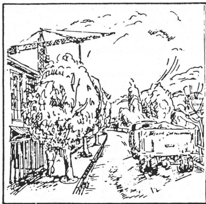
G: Industrierschliessungsstrasse, mit verbreitertem Trottoir, das die Anlage einer Baumallee ermöglicht.
