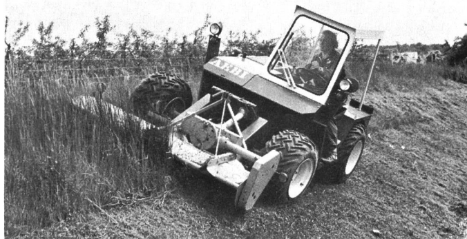
Terratrak mit Schlegelmäher an Autobahnböschung.
