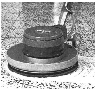
Bodenreinigungsmaschine Wetrok-Servomat 415E beim Fegen mit Wetrok-Autiwax.
