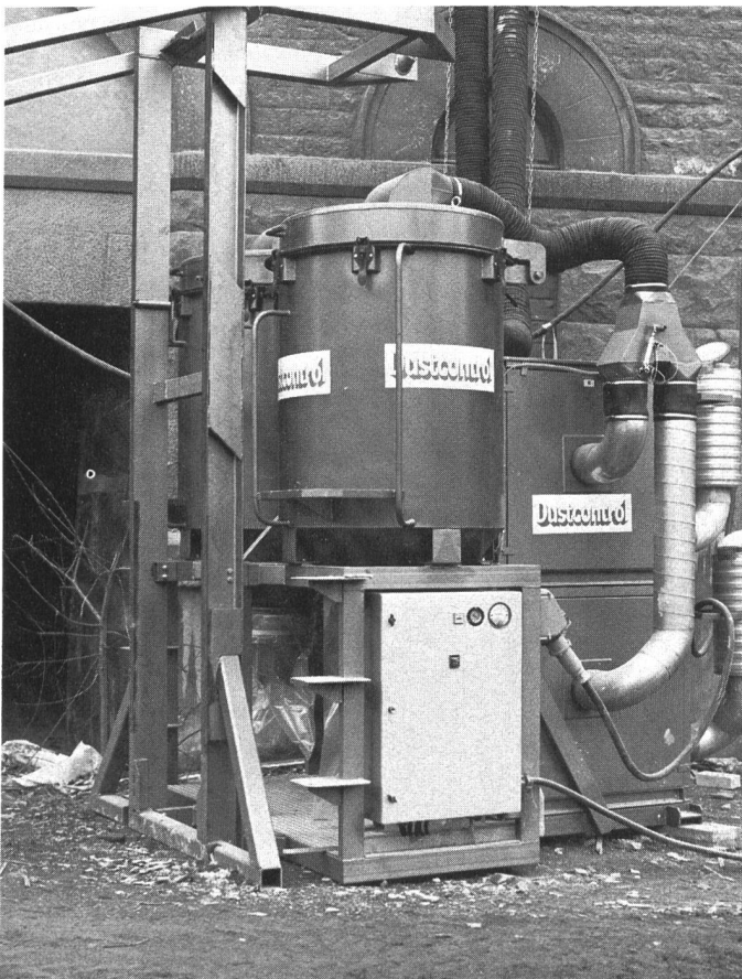
Staubabscheider DC Ventilation mobil, 37 kW, als Entlüftungsaggregat. Dieses Aggregat besteht aus zwei parallelgeschalteten Zyklonen vom gleichen Typ wie beim Hochdruckaggregat. Als Saugaggregat dienen zwei zweistufige Ventilatoren zu je 18,5 kW. Die gesamte Luftfördermenge beträgt ca. 10000 m 3 /Stunde.
