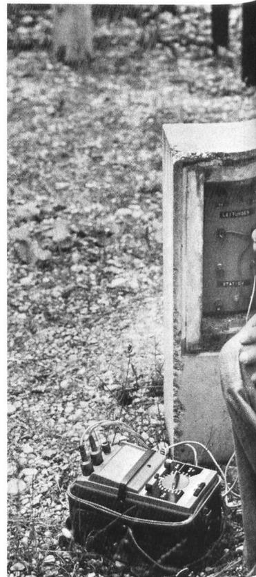
Messung des Kathodenschutz-Strompotentials an einer der Swissgas-Leitungen. Je Kilometer Hochdruckgasleitung...
