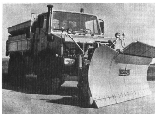
Mehrscharen-Federschneepflug mit Windleitschirm und Aufsatzstreuautomat auf Unimog 1700.
