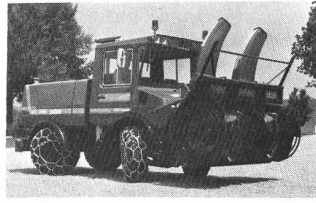
Spezial-Hochleistungsschneefräse Typ VF4 HM mit Vorderrad, Allrad- und Hundeganglenkung auf dem grossen Unimog U-1000.
