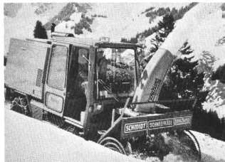
Spezielschneefräse Schmidt-Boschung, Typ FV-PF. Hydrostatischer Antrieb. Räumbreite wahlweise 1,4 oder 1,6 m. Durchmesser der Frästrommel 0,8 m. Höhe des Fräsvorbaus 1,1 m. Drehzahl der Frästrommel stufenlos verstellbar. Wurfweite etwa 15 m.
