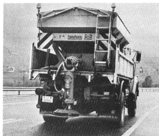
Aufsatzstreuautomat mit Mischsalzeinrichtung und Klappverdeck im Autobahneinsatz.
