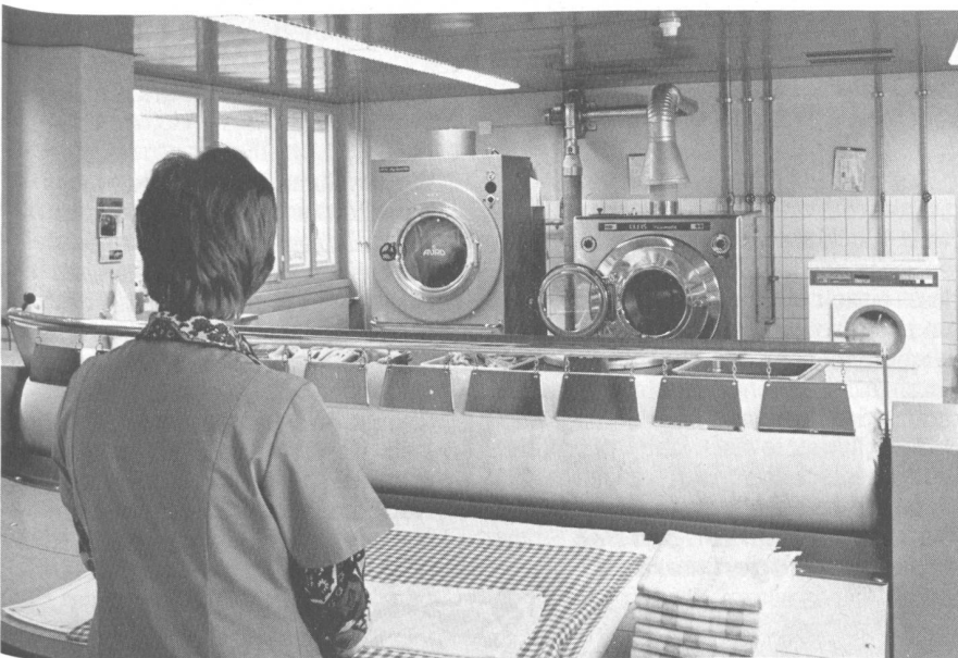
Hohe Umstellkosten bei gewerblichen Gasanwendungen: Wäscherei mit Gasmange (vorn), Gaswaschmaschine und Gastumbler.
