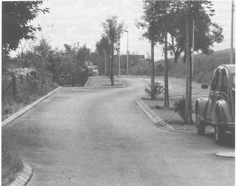
Auf der umgestalteten Neubergstrasse in Zurzach wird jetzt wirklich langsamer gefahren. Die Messungen der ETH haben eine Durchschnittsgeschwindigkeit von 29 und eine Spitzengeschwindigkeit von 38 km/h ergeben.
