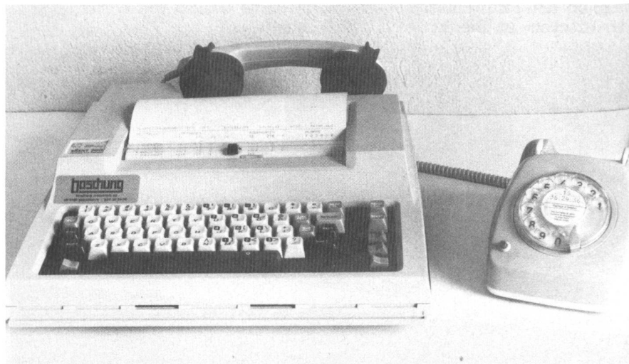
Abb. 11. Datenterminal mit Akustikkoppler für Datenübermittlung durchs Telefon.
