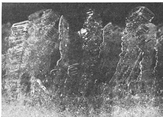
Bild 5: Oberflächenreif, niedergeschlagen auf der Altschneeschicht. Seitliche Ansicht im Schnitt (Vergrößerung 2 mal).
