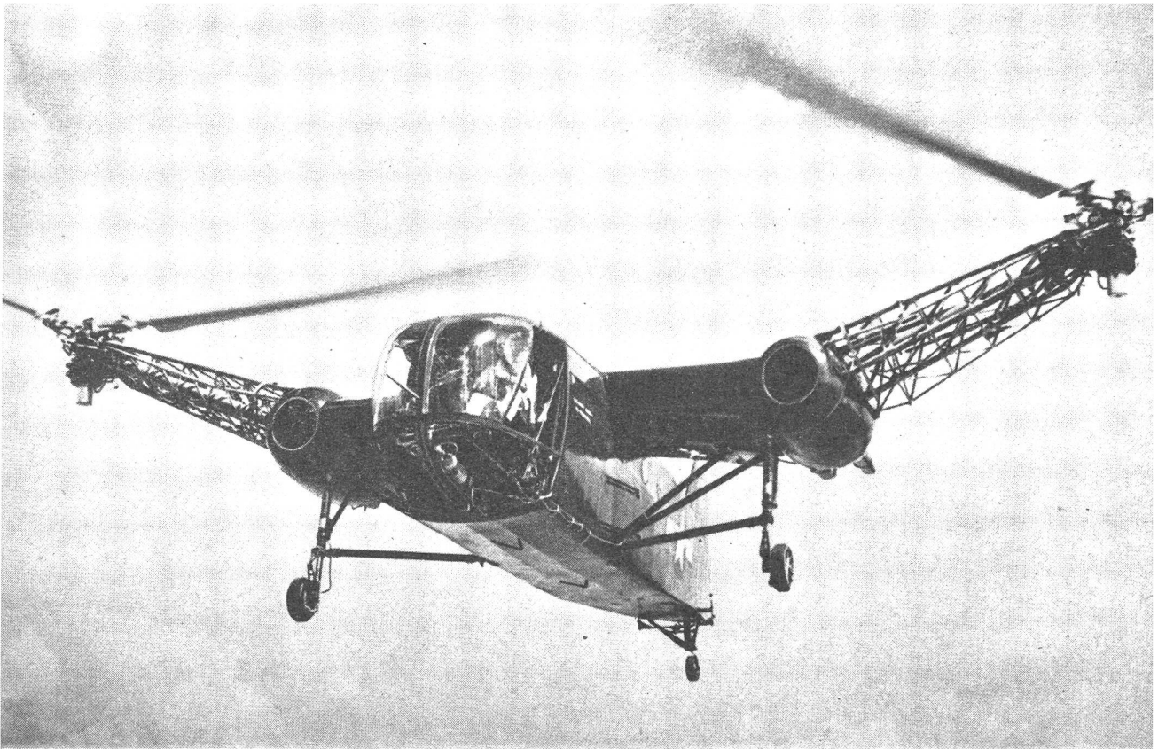
Bild 9: Hubschrauber der Mc Donnell Aircraft Corp. (USA) für die amerikanische Marine. Das Flugzeug besitzt zwei Luftschrauben, die wie bei Focke-Wulf auf zwei Auslegern angebracht sind. Der Antrieb erfolgt durch zwei Motoren, die aber starr miteinander gekuppelt sein müssen. Die Rotoren haben einen Durchmesser von 14 m. Das Flugzeug kann eine Nutzlast von 1360 kg tragen und erreicht eine Geschwindigkeit von 160 km/h.
