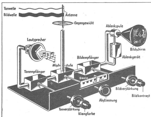
Bild 20: Aufbau eines Fernseh-Empfängergerätes für Ton und Bild.
